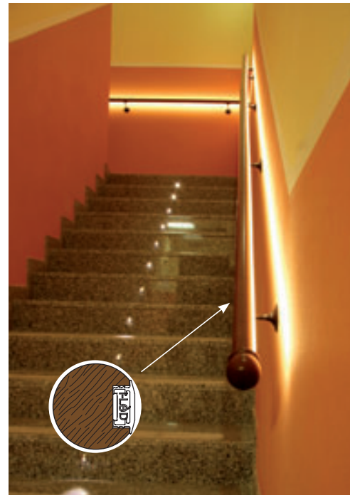
Esempio di montaggio su corrimano appositamente fresato Installation example on milled handrail
